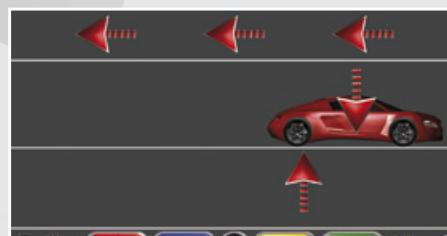
È possibile la misurazione del fuori centro spingendo il veicolo di 30° (compensazione rapida e in poco spazio)\* senza necessità di sollevare il veicolo.
