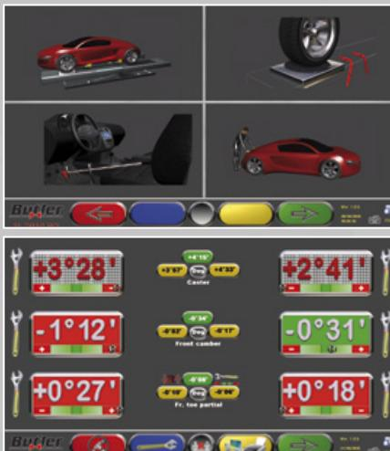
Il programma movie, tramite grafica animata 3D, visualizza la sequenza delle operazioni da effettuare per eseguire una corretta registrazione del veicolo.
