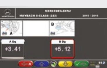
Dispositivo per rendere più rapida e precisa la misurazione dell'assetto. La banca dati modifica automaticamente le specifiche in funzione di altezza o inclinazione.
