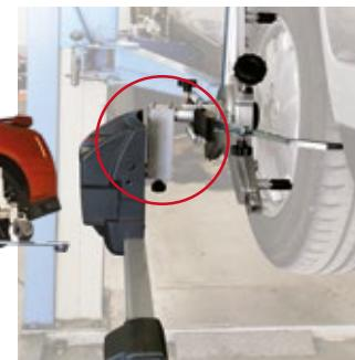
Con griffe a 4 punti l'adattatore **STDA154** non serve: basta sostituire i due grani (A e B) con due pomelli cod. 20519 (ogni griffo, totale 8). Questo consentirà di abbassare i rilevatori in caso di interferenza coi bracci del ponte.
